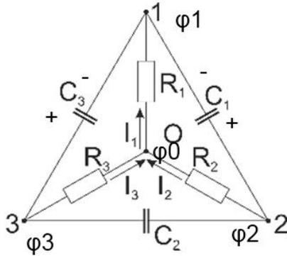
Ток  $I_2$  порожден разностью потенциалов  $\varphi_2 - \varphi_0$ , следовательно, записав закон Ома для участка цепи получим:
